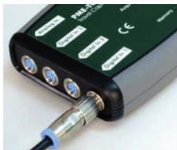
Permite la conexión de hasta 3 transductores digitales y 1 analógico al BUS PME. Funcionamiento Plug & Play.
