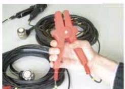
Pinzas tipo cocodrilo para soportar más peso en conexiones grandes. Combina conexiones de tiempo y de resistencia de contacto para montajes más rápidos.
