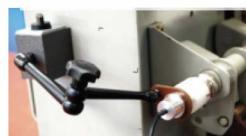
Transductor rotatorio, brazo articulado con cierre magnético y adaptador de diámetro.
